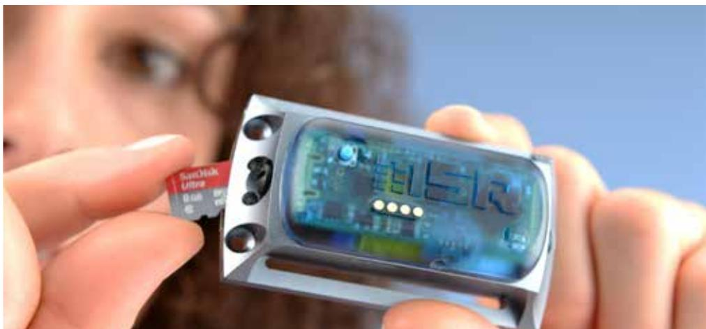
数据记录仪配有高分辨率三轴加速度传感器( $\pm 15\text{ g}$ 或 $\pm 200\text{ g}$ ), 可提供有关冲击、颠簸和振动的有价值的测量数据。MSR 165的测量频率为1600/s, 拥有大容量存储器和低功耗的特点, 是运输监测、故障诊断和负载测试等应用领域的理想选择!
