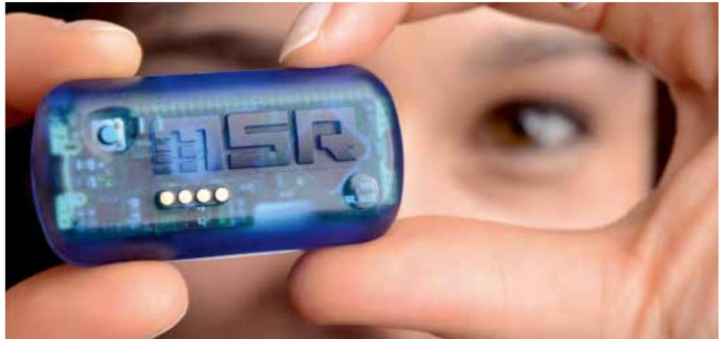
这款拇指大小、瑞士质量的MSR145数据记录仪能够同时测量和记录各种测量值例如温度、湿度、压力、3轴加速度和光线。
