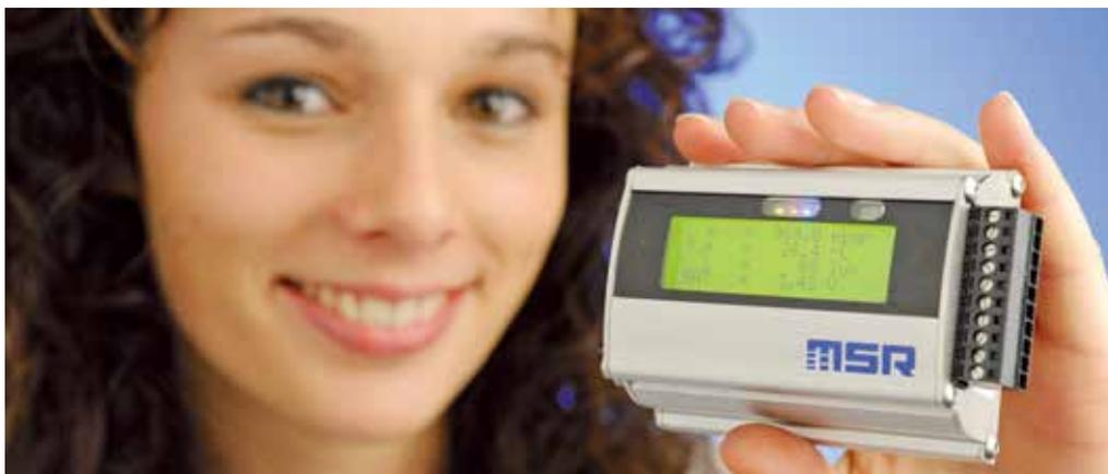
紧凑型的MSR 255具有多达五个不同的传感器，四个附加的模拟输入和易于阅读的LCD屏幕，为您提供最大的灵活性和友好的用户界面。
