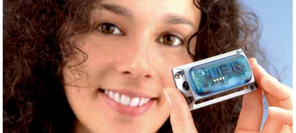
新型MSR 160数据记录仪的主要特征是：四个模拟输入、高测量速率、巨大的存储容量，及微型体积。坚固的迷你记录仪的模拟输入可用于具有模拟输出的常规传感器(例如CO<sub>2</sub>、电导率、pH等)。另外，还提供多输出开关电源。
