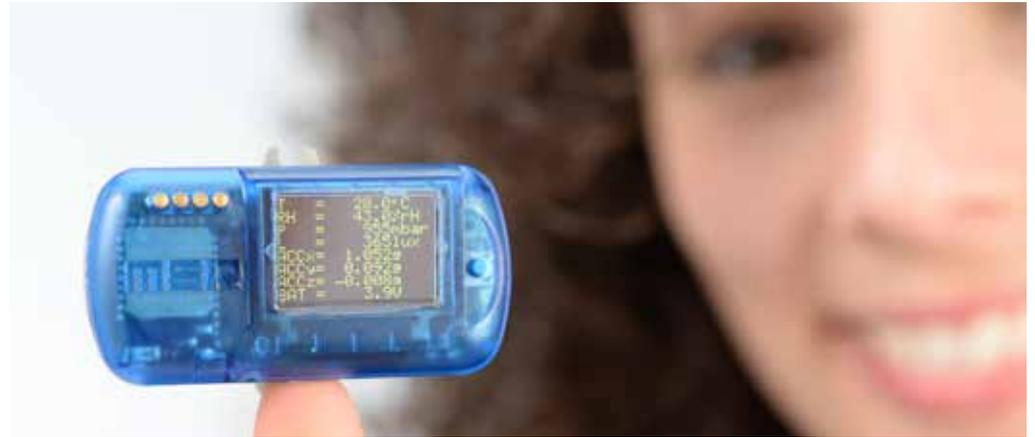
无线数据记录仪(WiFi), 用于监测温度、湿度、流体压力、空气压力、光线、加速度、应变仪和更多。
